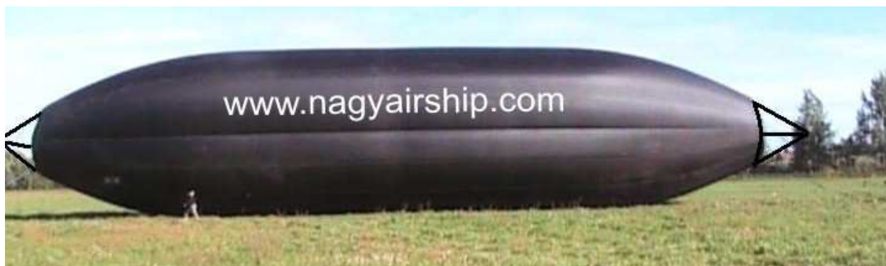
A műszaki ellenőrzés céljából felfújt prototípus léghajó teste.
